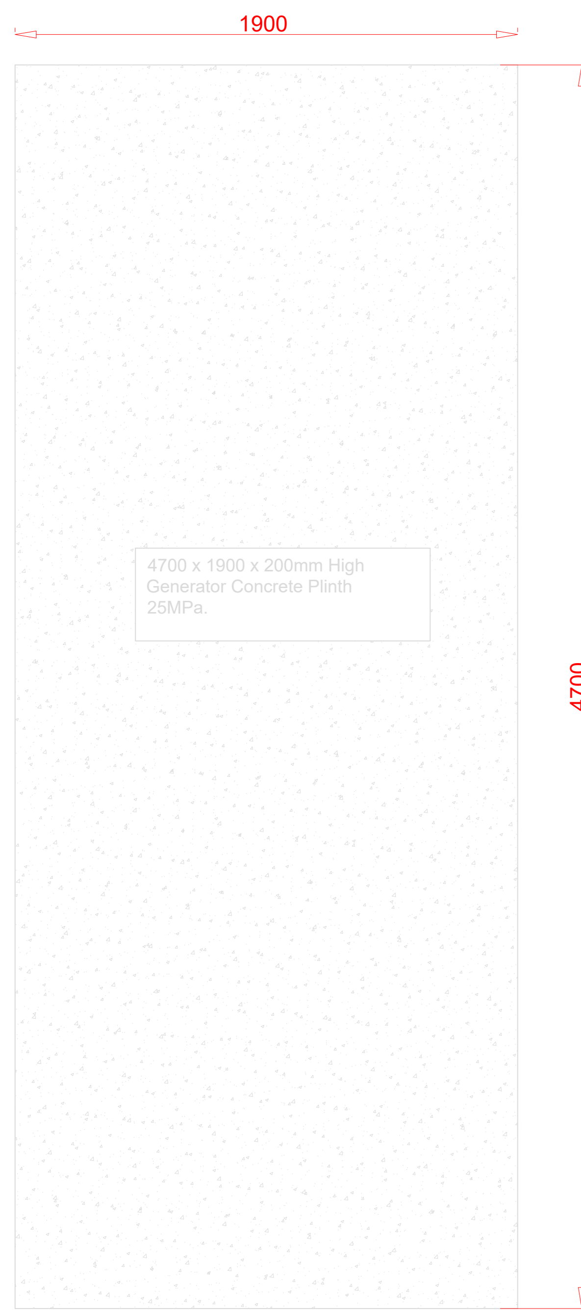
PLINTH PLAN Scale N.T.S
