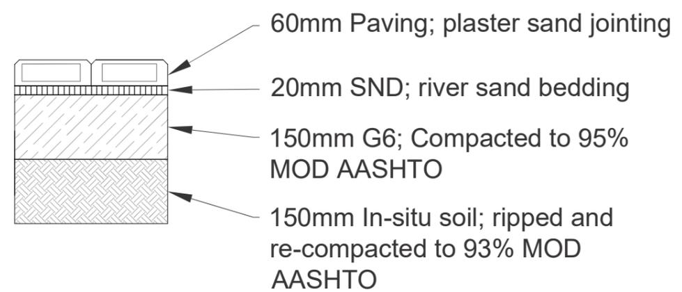
**PAVING LAYER WORKS CROSS-SECTION**
